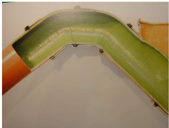
Abb. 4: bogengängiger Liner im Hausanschlussbereich
