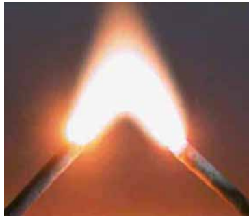
Bild 1: Lichtbogen zwischen zwei Stahlnägeln
