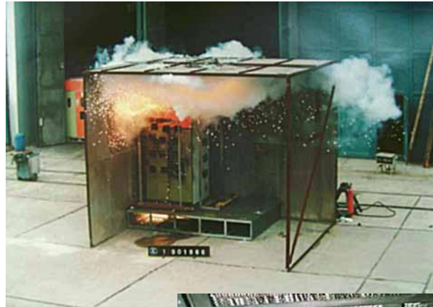
Bild 5: Störlichtbogenprüfung an einer Mittelspannungsschaltanlage
