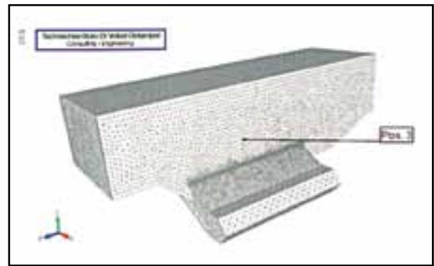
Bild 3: Konstruktiv relevanter Teil des Transportwagens: FEM-Modellierung mit Vernetzung
