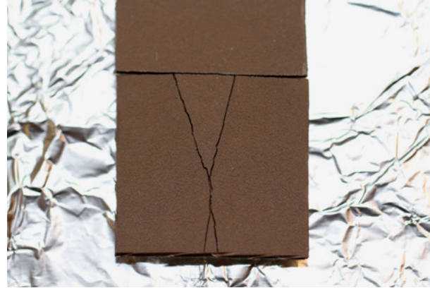
Abbildung 12: Bei minus 18^{\circ}\text{C} gelagerte Probe mit spontaner Rissbildung
