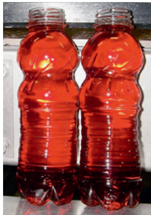
Abb. 4: deformierte PET Flaschen
