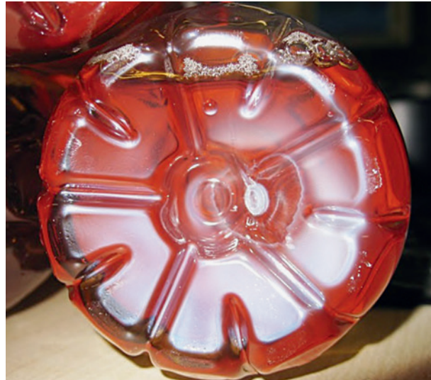
Abb. 5: versetzter Anspritzpunkt PET Flasche
