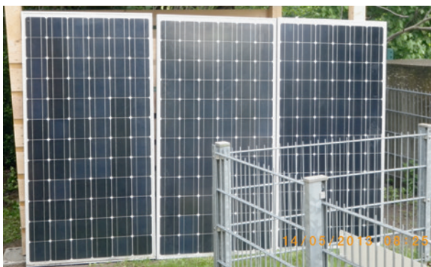
Abb. 3: Oberfläche eines bereits verlegten und anschließend ausgebauten Photovoltaikmoduls aus dem Dach der Ziegelei
