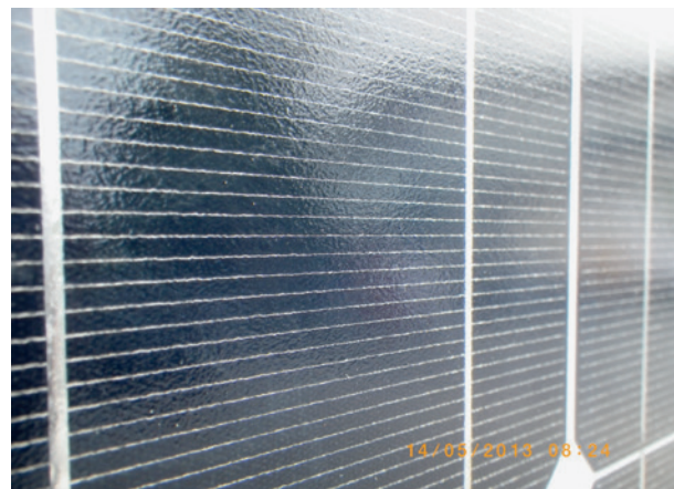
Abb. 2: Oberfläche der Referenzprobe, des noch nicht verbauten Photovoltaikmoduls
