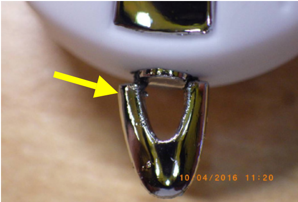
Abb.1: Beispielhafter USB-Stick mit einem sichtbaren Schaden an der Öse (mit Pfeil markiert).
