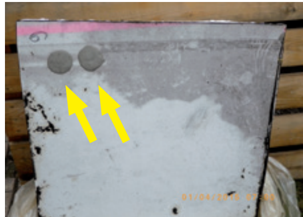
Abb.1: Stück einer bereits verlegten und ausgebauten PVC-Folie, die an ihrer Oberfläche helle und dunkle Bereiche (makroskopisch mit einer scharfen Grenze getrennt), sowie Ausbesserungen (mit Pfeil markiert) aufweist.
