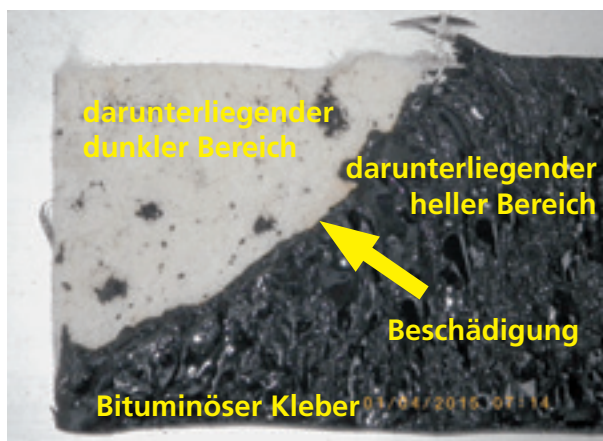
Abb. 4: Sichtbare Beschädigungen an der Unterseite, an der Grenze zwischen dem hellen und dunklen Bereich, Bildbreite ca. 8 cm.
