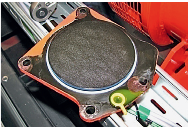
Bild 5: Fabrikneuer, kleiner O-Ring in eingebautem Zustand in einem neuen Aggregat
