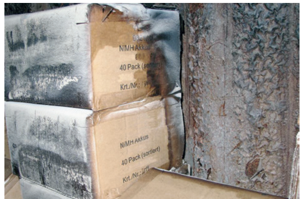
Bild 4: Durchfeuchtung der Kartons (die Beschriftung wurde anonymisiert)
