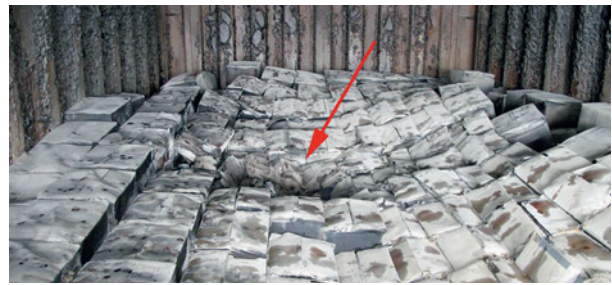
Bild 3: Innenansicht des Containers im Anlieferungszustand. Der Brandtrichter ist mit einem Pfeil gekennzeichnet
