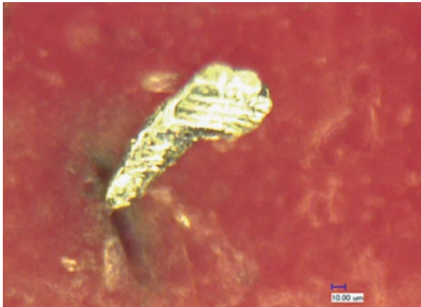
Abb. 1: Metallsplinter, scharfkantig und zusammenhängend in Beschichtung der Farbübertragungswalze
