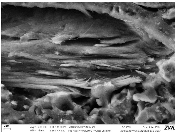
Abb. 3 REM-Aufnahme von Asbestfasern (Chrysotil) bei 2.000-facher Vergrößerung in einem seit 30 Jahren verlegten PVC-Bodenbelag
