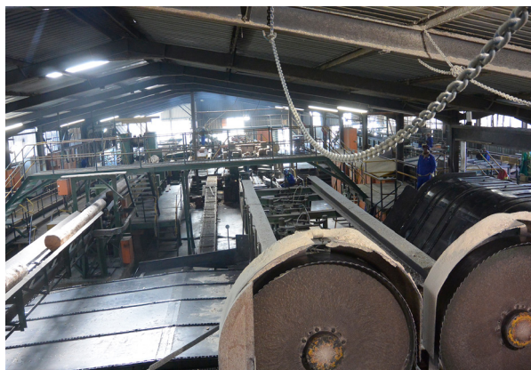
Abb. 3 Sägehalle mit Gattersägenlinie mit Nachschnittgatter (links), Tandem-Bandsäge mit Nachschnittkreissäge (mittig) und manueller Seitenwarensäumanlage (rechts)
